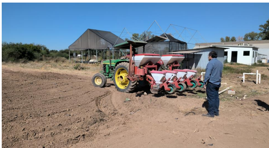
Figura 2. Siembra de maíz utilizando sembradora maquinaria de precisión marca óptima.
